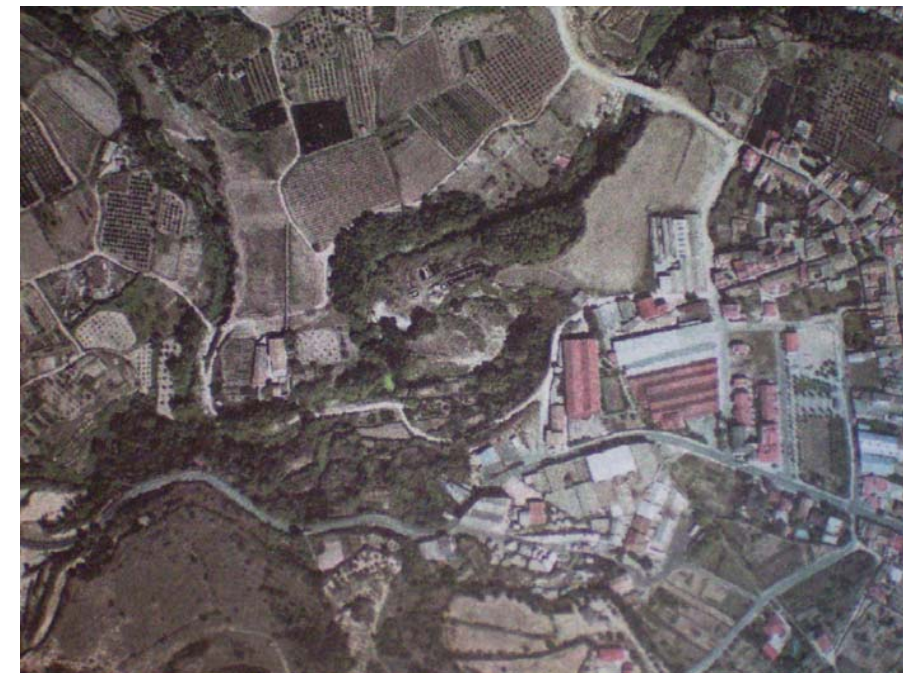
Meandres de la riera de Sant Pere relacionats amb la presència d'una fractura
